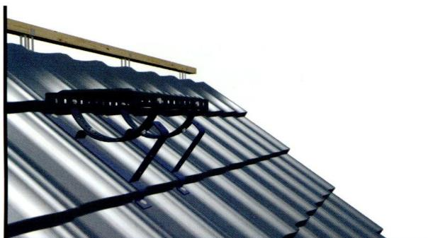
Po upevnení druhé konzoly s upevnením (pomocou priložených skrutiek) je treba priskrutkovať kominársku lávku. Potom skontrolujte správnosť vykonanej montáže, najmä by sa mala skontrolovať stabilita všetkých mechanických spojov.
